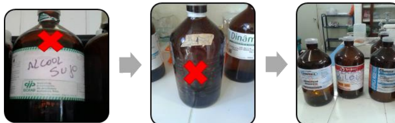
Figura 11. Etiqueta colada e escrita por cima do original, frasco sem rótulo ou escrever por cima do rótulo são atitudes erradas.
