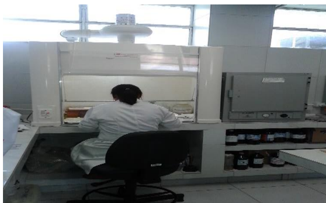
Figura 5. Capela com exaustores.
