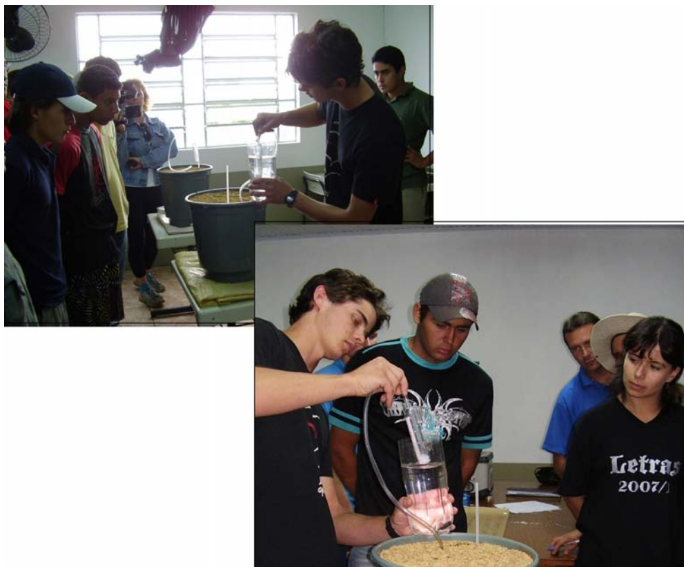
Figura 1 – Estação com tema: manejo racional da irrigação com uso do Irrigás Básico
