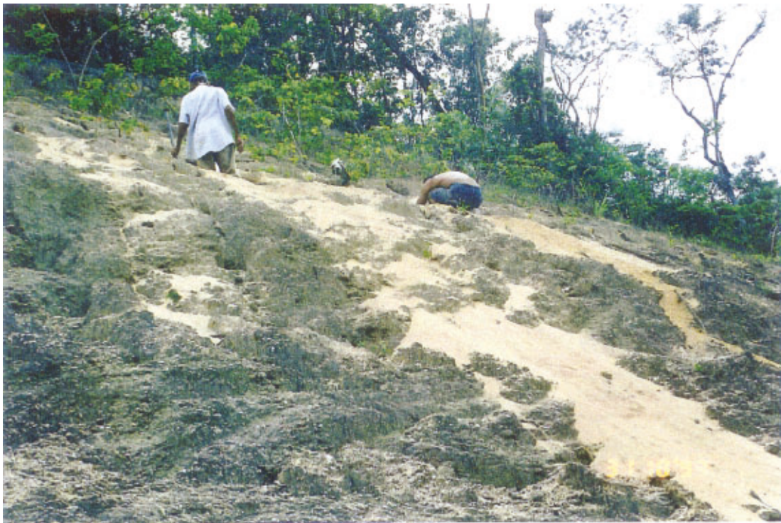
Figura 37 – Escavação para estudo do sistema radicular em taludes.
