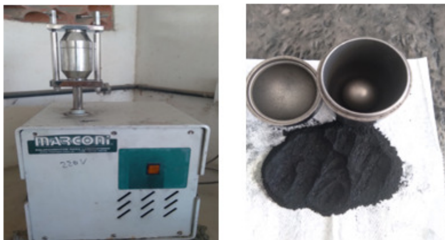
Figura 2. Moinho de bola e carvão vegetal (biocarvão) triturado. Fotos: Arcevo do Autor.
