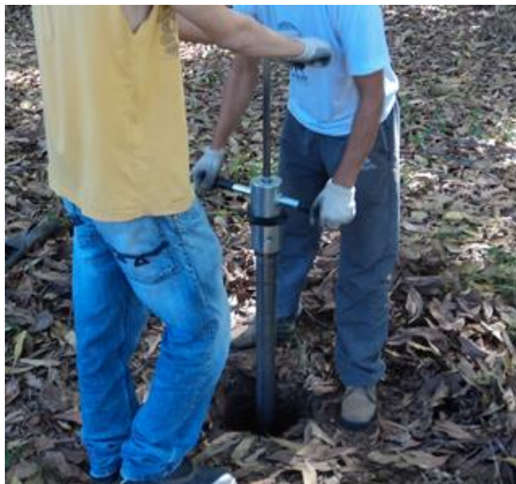
Figura 6: Sonda utilizada para a coleta de raízes finas.
