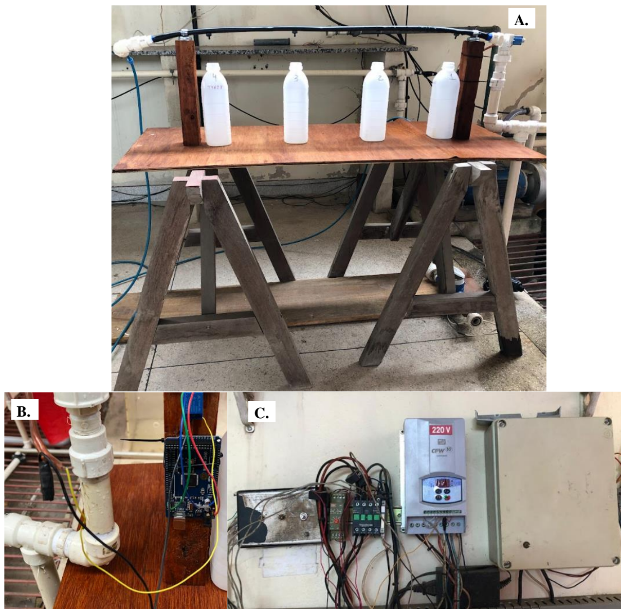
Figura 11 – A. Bancada de ensaio; B. central de controle do ensaio; C. Estação de controle do conjunto motobomba
