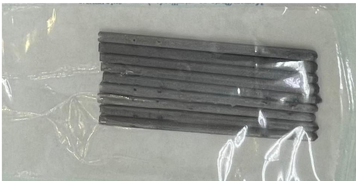
Figura 20. Conjunto de 9 hastes recém impressas, acondicionada em envelope de papel grau cirúrgico antes da aplicação nos ossos.
