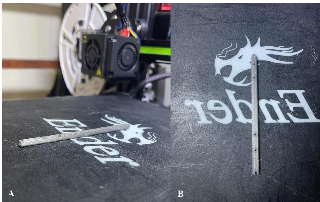
Figuras 19. A - visualização de uma das hastes de polímero recém impressa, na mesa de impressão da impressora Ender 3 B – mesmo implante de uma visão superior
