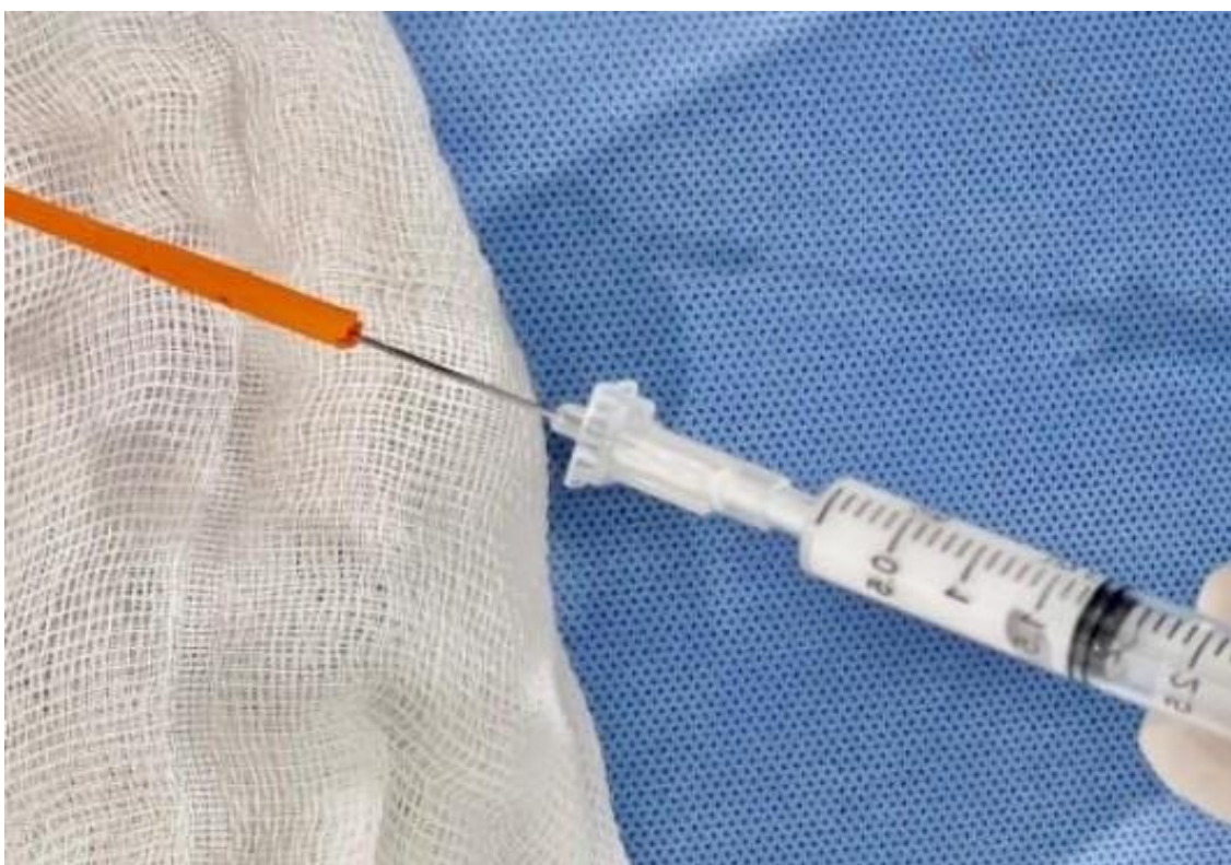
Figura 25. Aplicação do contraste a base de sulfato de bário em uma das hastes de polímero do experimento.
