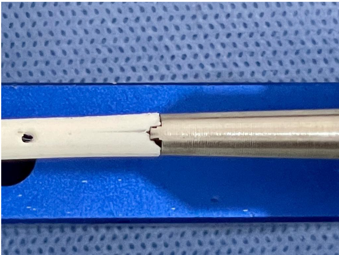
Figura 36. Detalhe da compatibilidade de encaixe entre a haste desenvolvida e o instrumental de aplicação do implante (aplicador manual) da marca comercialmente existente adotada no experimento (PROTOMED).
