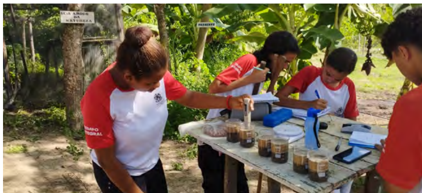
Imagem 9 – Análise da condutividade elétrica do solo utilizando um condutivímetro para a medida.
