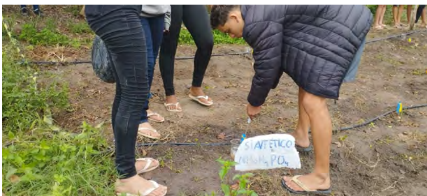
Imagem 11 – Coleta da solução do solo para análise da condutividade elétrica após o plantio de feijão.
