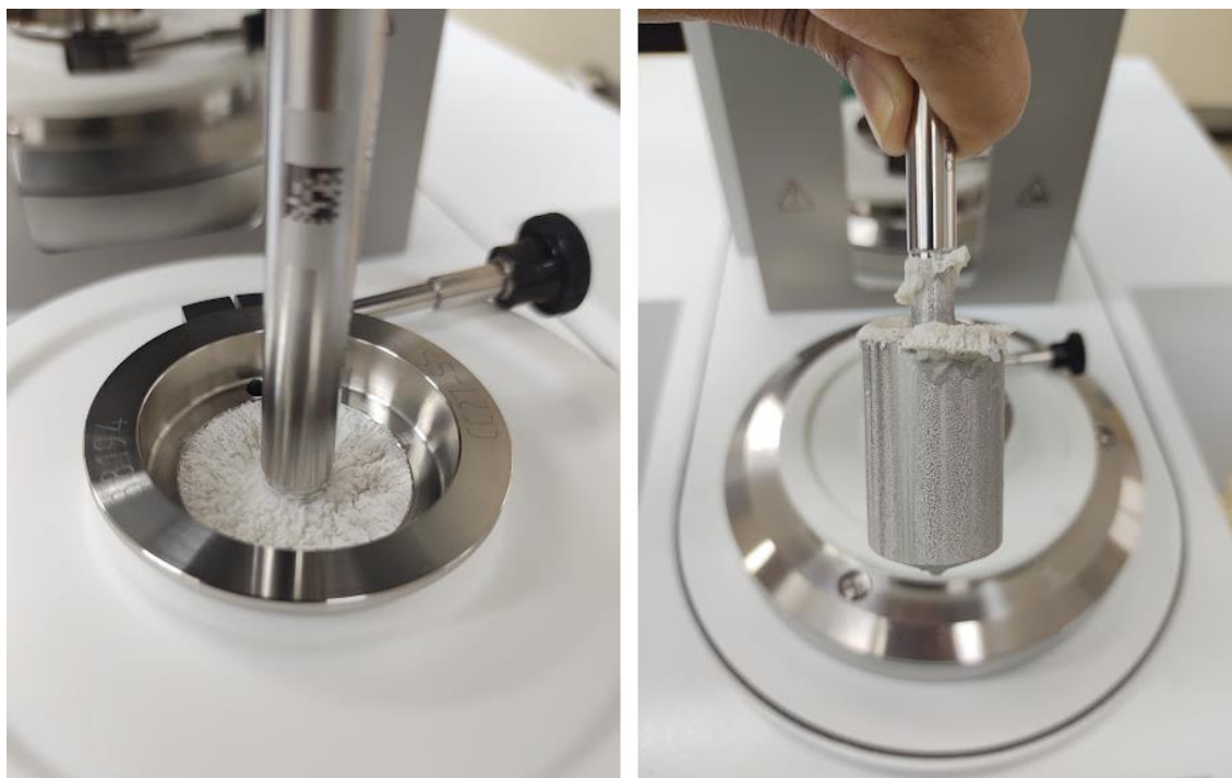
Figura 43. Aspecto do fluido base água adensado durante e após análise a 55°C na geometria de cilindros concêntricos.
