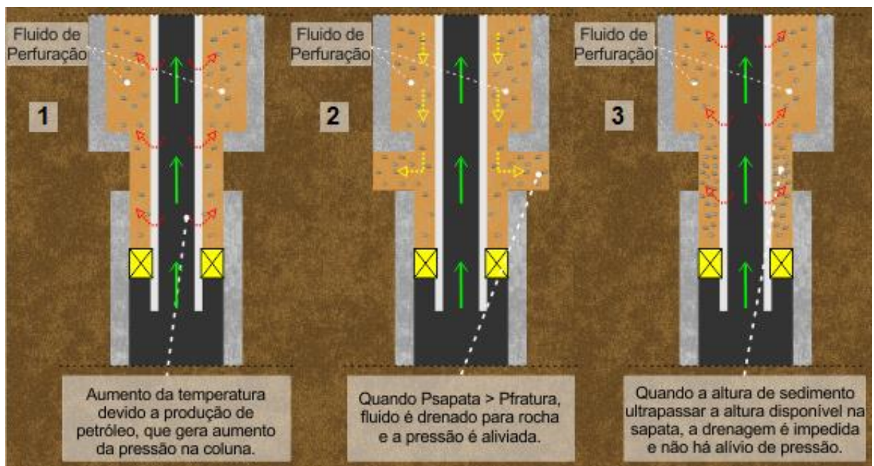
Figura 5. Ilustração do poço em produção (1), do alívio da pressão (2) e da sedimentação impedindo o alívio (3).
