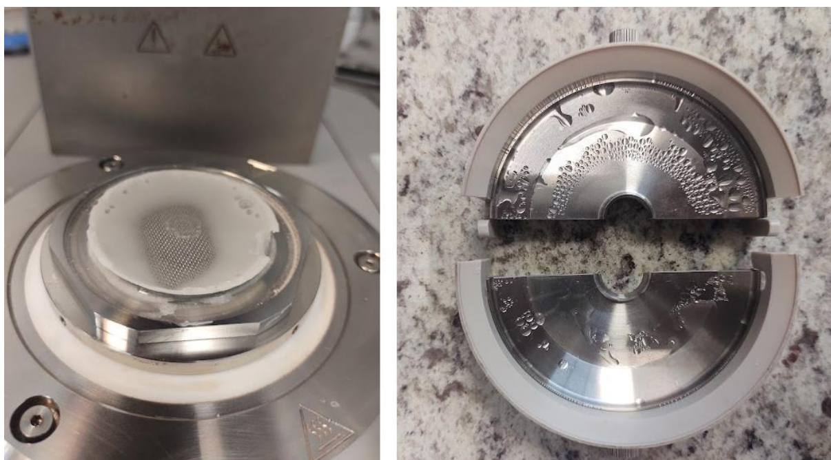
Figura 55. Problema de evaporação de solvente em fluidos base água para experimentos a 55°C.
