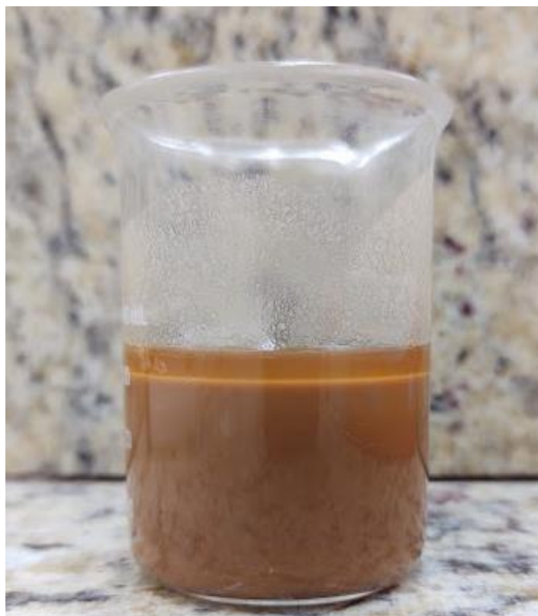
Figura 44. Aspecto do fluido base óleo adensado imediatamente após análise a 85°C na geometria de cilindros concêntricos.
