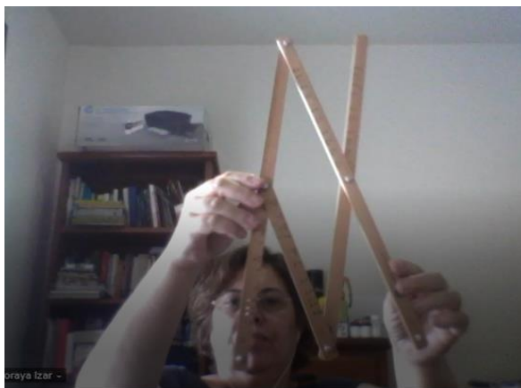
Figura 38. Pantógrafo de Scheiner
