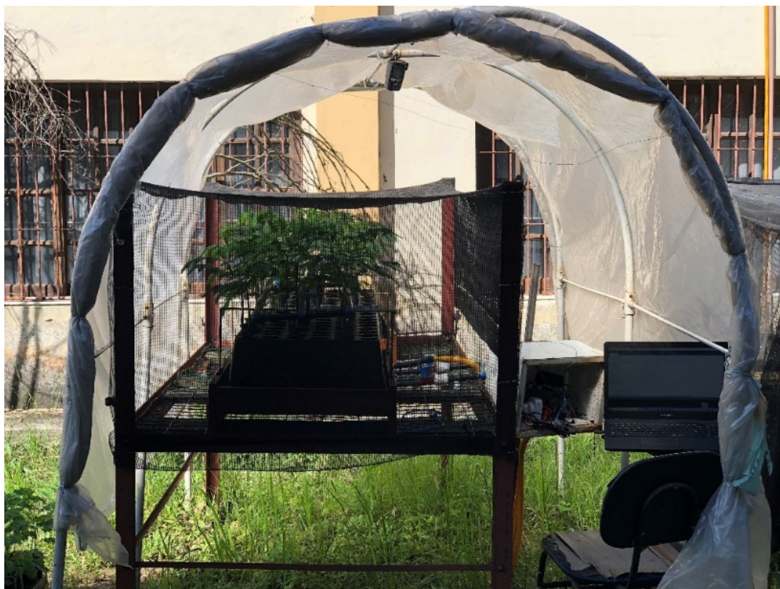
Figura 15. Bancada experimental com os mini-lisímetros coberta com lona plástica.
