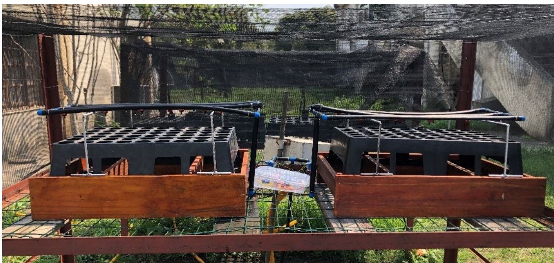
Figura 14. Mini-lisímetros com a malha de irrigação por gotejamento.
