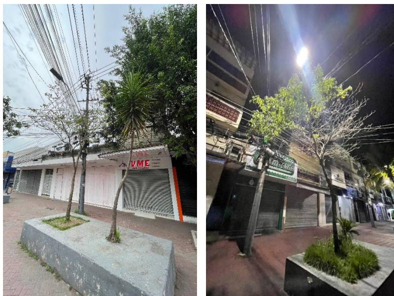
Figura 18. Ocorrência de conflito entre fiação e indivíduos arbóreos com altura inferior a 6,0 m plantados em “canteiros suspensos” no Calçadão do município de Itaguaí/RJ.
