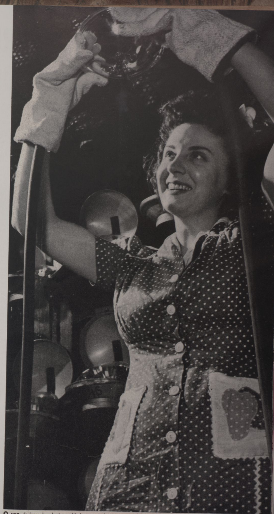
O uso de luvas de asbestos resfriadas a ar, pelas operárias que se encarregam do trabalho de fazer a separação de peças de material elétrico, quando são retiradas do forno, foi idéia da enfermeira da oficina. Dessa maneira evitam-se as frequentes queimaduras e o tempo necessário para o seu tratamento. O resfriamento é feito por dois tubos
