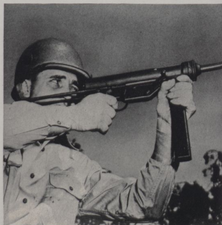
De dimensões tão pequenas que pode ser conduzida numa pasta de papéis, e tão simples que pode ser fabricada economicamente, a sub-metralhadora M-3, dispara 450 projéteis por minuto
