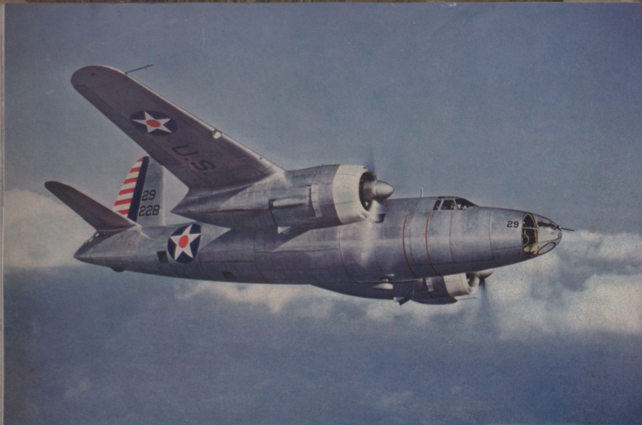
B-26 Este bombardeiro médio (em cima) tem sido considerado como uma maravilha de aerodinâmica. De linhas firmes e suaves e de extrema precisão de movimentos, corta os ares levando em seu bojo uma carga de três toneladas de bombas, e desenvolve uma velocidade, máxima de qualquer bombardeiro, de mais de 480 quilômetros à hora. Suas hélices de quatro pás são acionadas por dois motores de 1.850 CV
