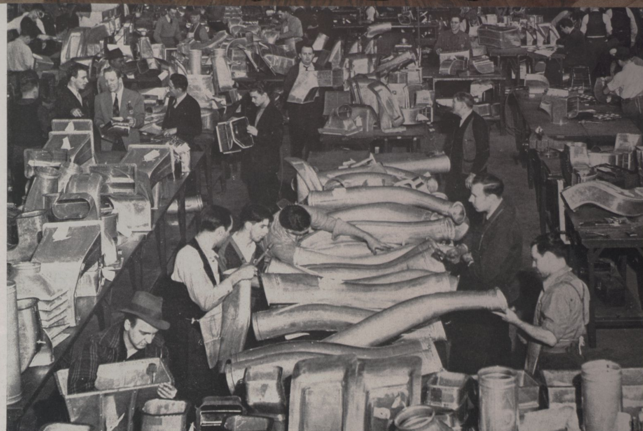
Aspecto de uma fábrica de automóveis há pouco convertida para a produção de guerra: tubos de descarga para aviões de bombardeio são agora ali fabricados por métodos de produção em série, em trabalho contínuo, de milhares de tubos por dia
