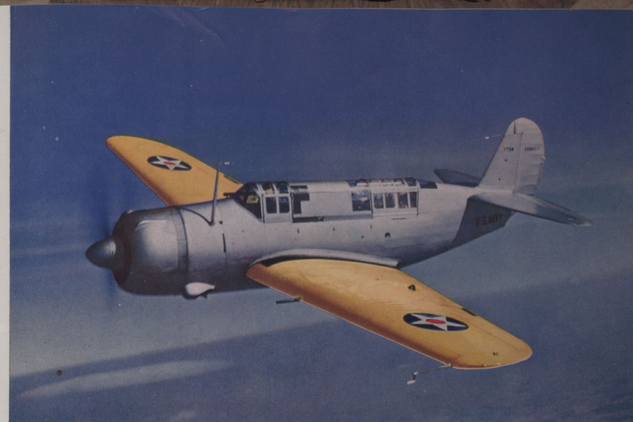
SB2C-1 Este avião de bombardeio em mergulho, o mais moderno da Marinha (em cima), é considerado muito superior a qualquer aparelho do seu tipo no mundo. É construído pela Curtiss e desenvolve uma velocidade horária de 560 quilômetros, sendo o seu raio de ação de 1.900 quilômetros, carregando uma tonelada de bombas na fuselagem. Do seu armamento consta um pequeno canhão montado nas asas
