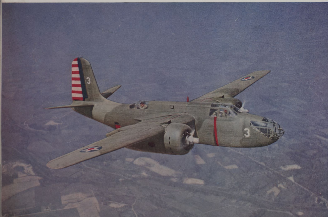
B-26 Este bombardeiro médio (em cima) tem sido considerado como uma maravilha de aerodinâmica. De linhas firmes e suaves e de extrema precisão de movimentos, corta os ares levando em seu bojo uma carga de três toneladas de bombas, e desenvolve uma velocidade, máxima de qualquer bombardeiro, de mais de 480 quilômetros à hora. Suas hélices de quatro pás são acionadas por dois motores de 1.850 CV
