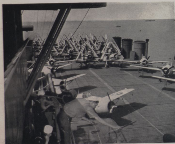
Os pequenos e velozes aviões de caça da Marinha dispõem de asas dobradiças, a fim de ocuparem o menor espaço possível, quando acomodados no hangar sob a coberta.
