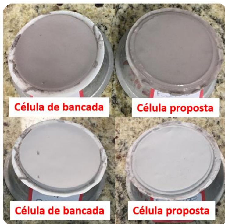
Figura 50. Tortas de filtração úmidas e secas, respectivamente, obtidas em ambas as células para o fluido de concentração de 1,0 lb/bbl (GX) e 15% v/v de barita.
