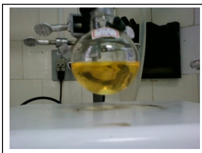
Figura 65. Foto da reação do composto 5 com sulfeto (1:3) em pH 7 antes da adição de sulfeto.
