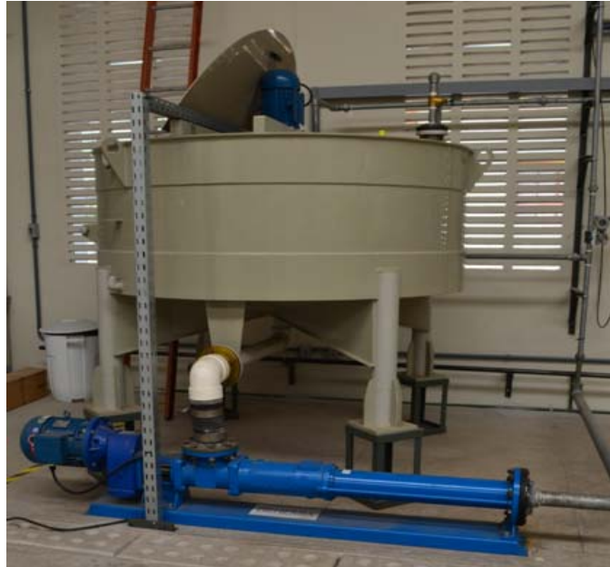
Figura 3.10 - Bomba helicoidal conectada ao tanque principal.
