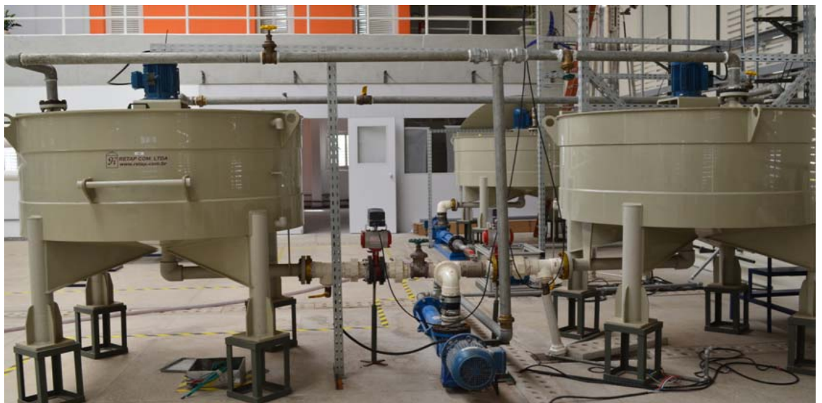
Figura 3.11 - Bomba helicoidal conectada aos tanques de lama.
