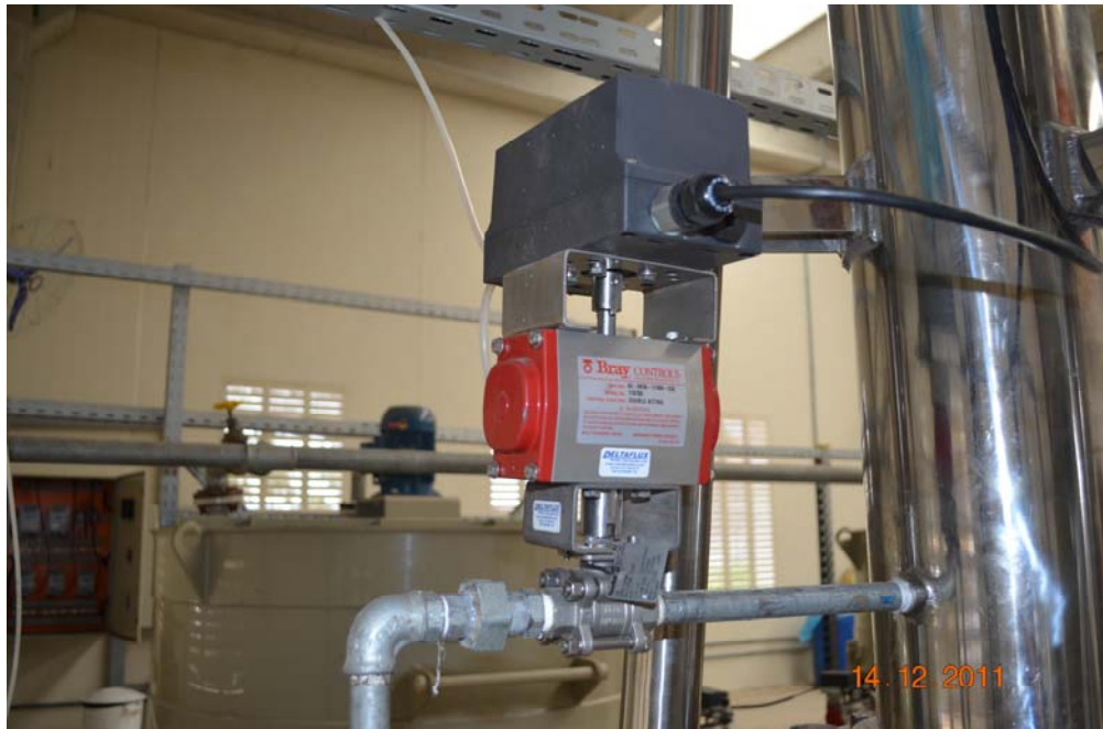
Figura 3.7 - Válvula com esfera caracterizada para retratar diferentes permeabilidades rochosas.
