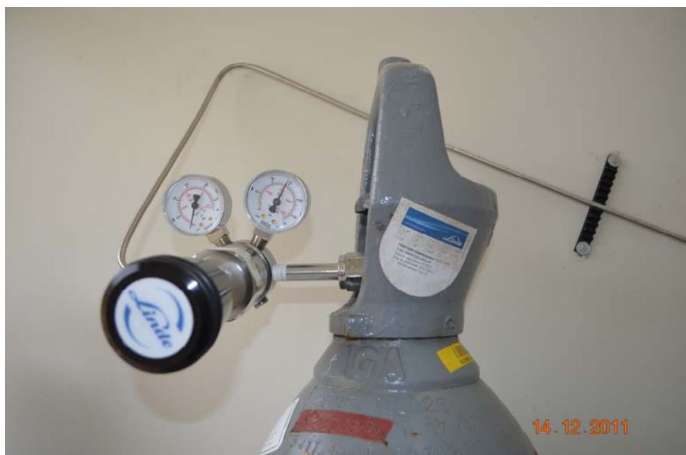
Figura 3.5 - Cilindro de ar comprimido, conectado a um regulador pistão alta/alta.
