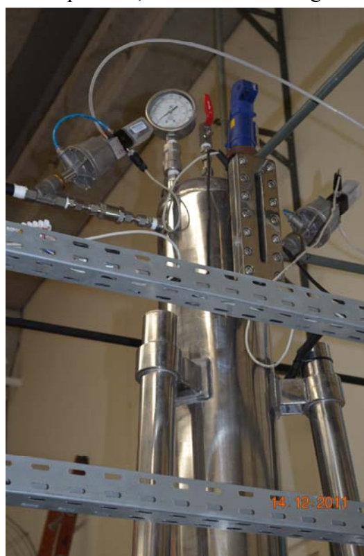
Figura 3.5 - Cilindro de ar comprimido, conectado a um regulador pistão alta/alta.
