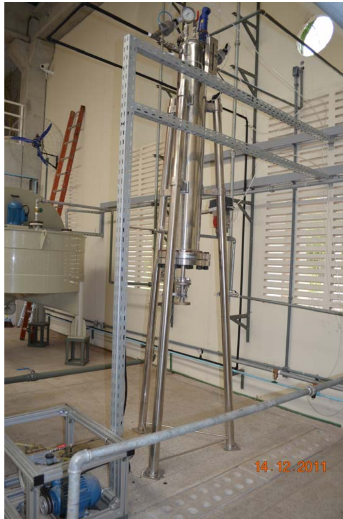
Figura 3.4 - Tanque de pressão, representando o reservatório de óleo e gás.
