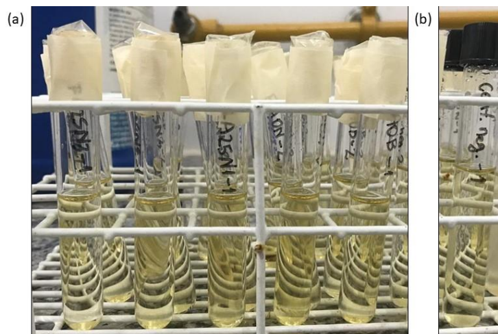
Figura 38 - Resultados do crescimento microbiológico, após exposição de 28 dias, (a) das amostras e (b) do controle negativo.
