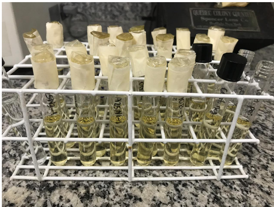
Figura 37 - Montagem do experimento de permeação microbiana.
